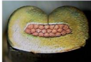
Zuordnungsfehler: Der Nennquerschnitt der Leitung passt nicht zum Crimpkontakt.
