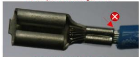
Fehler: Kein Auslauf vorhanden
