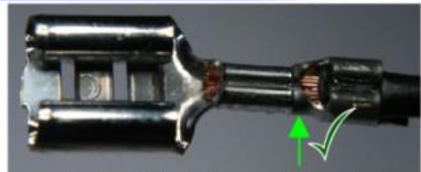
I.O. ausgeführter Drahtcrimp mit Auslauf
